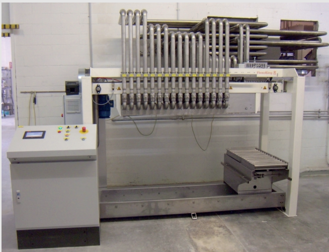
Gravimetrische Abfüllanlage für 32 Komponenten mittels fahrbarer Waage. Alle Komponenten sind mittels Verrohrung verbunden mit festen Lagertanks und IBC Container.
